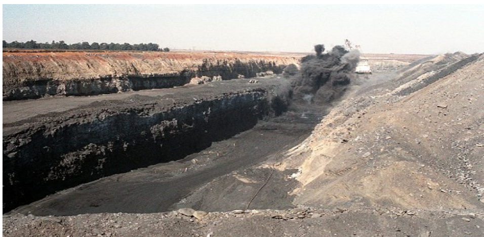
شکل ۲-۱- رخنمون زغالسنگ به صورت نوارهای تیره رنگ که به طور بین لایه‌ای در میان چینه‌های روشن‌تر قرار گرفته‌اند [۱].
